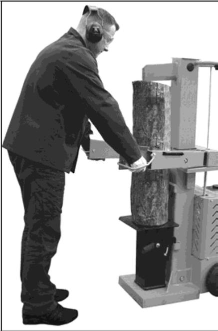
**i** Dysfonctionnement possible lors du fendage de bois long : la pièce à fendre n'est pas complètement fendue, s'est coincée dans la lame et remonte avec le mouvement de retour.
