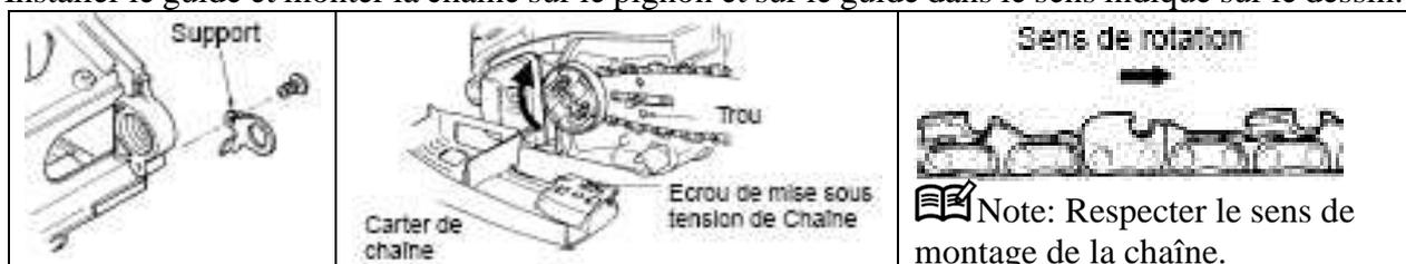
5. Ajuster l'écrou de mise sous tension de la chaîne dans le trou inférieur du guide, puis installer le carter de la chaîne et fixer l'écrou de montage selon la force de ses propres doigts.
