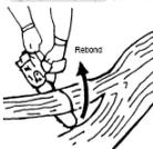
21. Lorsqu'on coupe une branche en flexion, prendre garde au rebond au moment où les fibres porteuses sont sectionnées.
