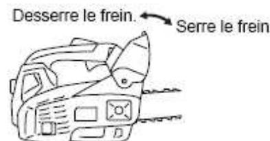
**Desserrage du frein:** tirez le levier de frein vers le haut jusqu'à ce qu'il se mette en place avec un déclic.
