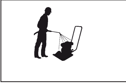
Lavage de la machine
