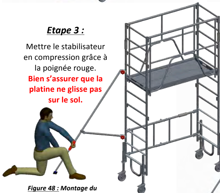
Figure 46 : Montage du stabilisateur : accrochage du bras
