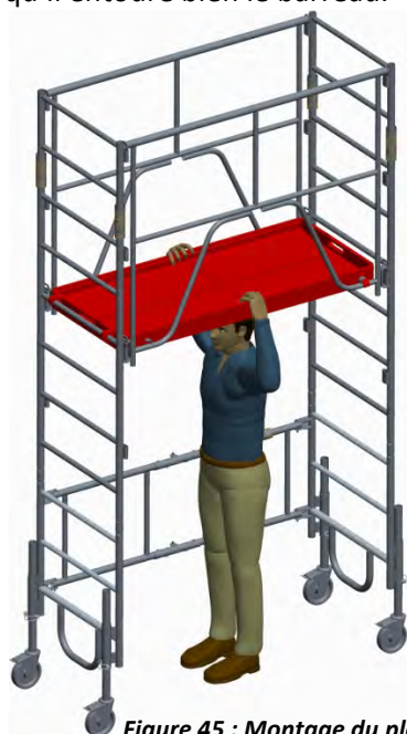
Figure 45 : Montage du plancher : positionnement des crochets longitudinaux
