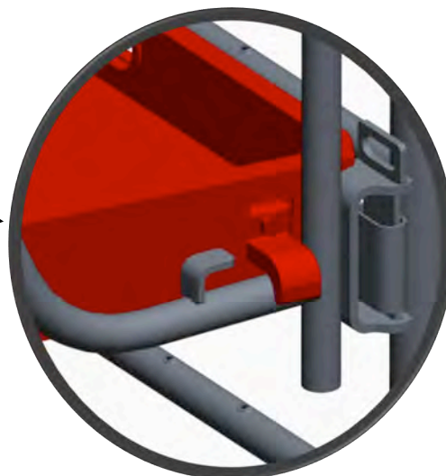
Figure 43 : Montage du plancher : zoom positionnement des crochets latéraux
