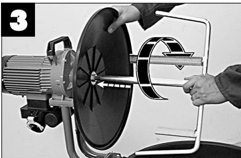
Introduire le bol dans le châssis inférieur en veillant à loger l'une des quatre poignées de transport dans la languette métallique prévue à cet effet. De cette façon, on évitera la rotation du bol pendant le mélange du produit.
