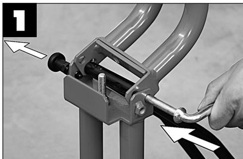
Die Komponenten entsprechend der in Abbildung 2 dargestellten Reihenfolge einsetzen, dann alles mit dem mitgelieferten 22-mm-Inbusschlüssel festziehen.
