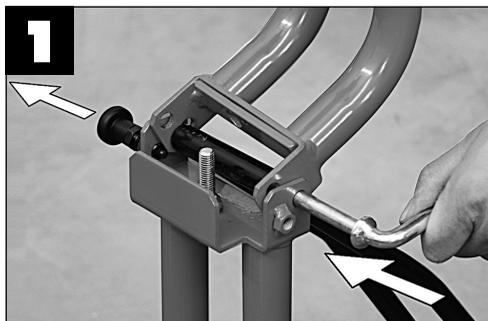
Introduzcan todos los componentes en secuencia según la figura 2. Bloquear todo utilizando la llave hexagonal de 22 mm que se entrega con la máquina.
