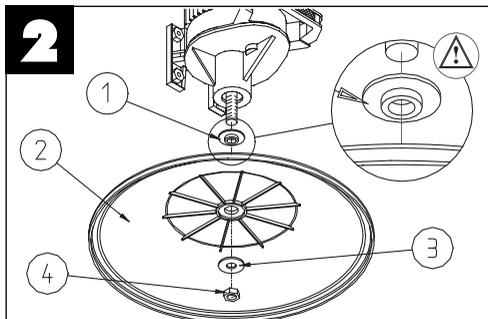
Enrosquen a tope el agitador sobre el cuerpo del motor.
