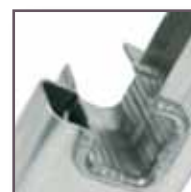
Echelons carrés 30 x 30 mm, Liaison montant - échelon, sertie, triple expansion
