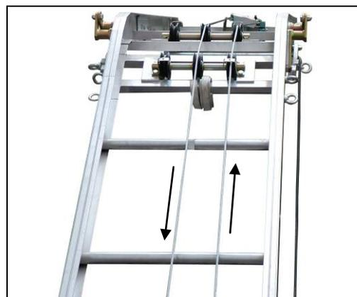
Fig. 37 Passage du câble sur la pièce coudée.
