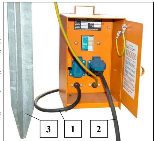
Fig. 17 Petit distributeur de courant de chantier
