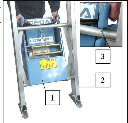
Fig. 31 Placer le treuil.
