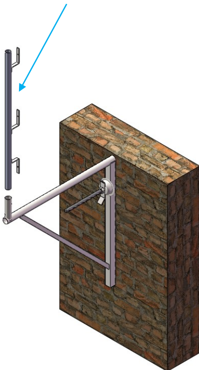
Mise en place des montants
