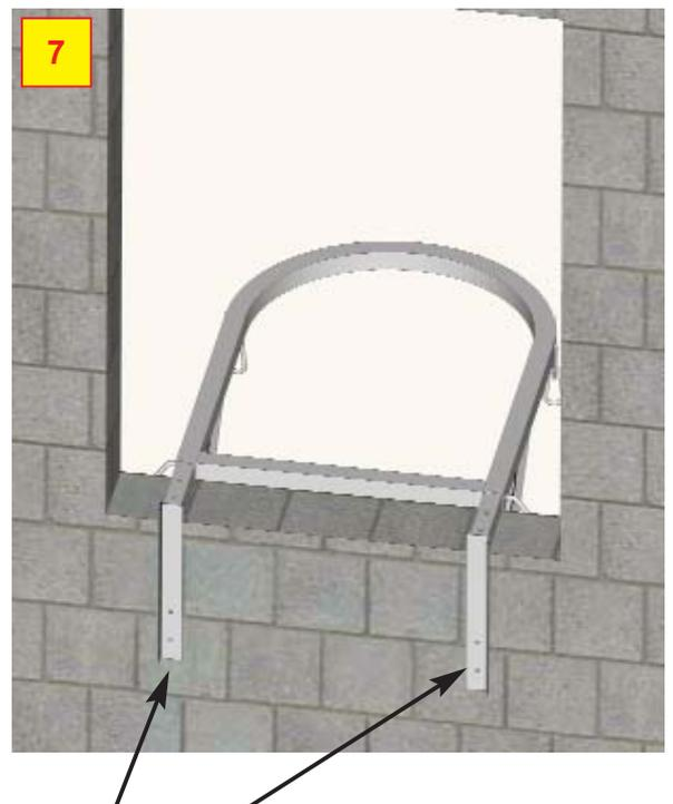
Dans certain cas il peut être nécessaire d'ancrer l'arrière du cadre de départ dans la maçonnerie.
