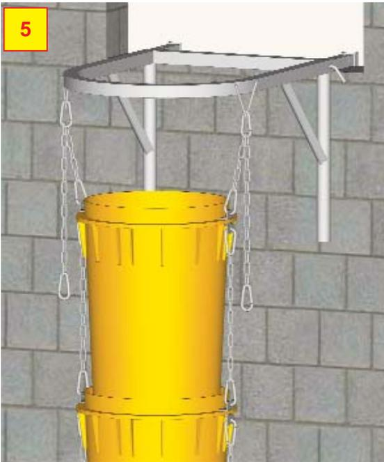
Après avoir remonté l'ensemble (photo 4), régler et accrocher la première goutte au cadre de départ à l'aide des 2 mousquetons (photo 5). Poser la goutte de départ sur le cadre (photo 6).
