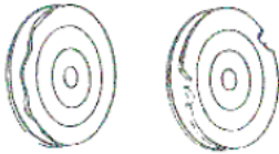
Broken edge pulleys
